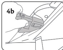
**Trava de giro 360:** Alinhe a roda para o encaixe da trava de giro e pressione para cima.
