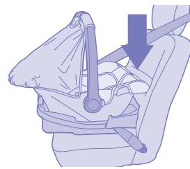
Para travar o bebê conforto deslize-o na direção das travas conforme seta da figura
