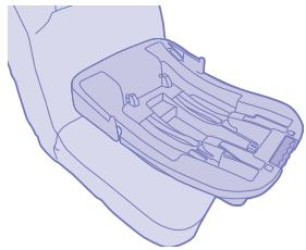
Posicione a base no banco com a alavanca voltada para a frente do veículo.
