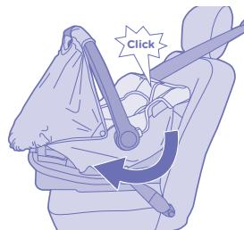
Encaixe o bebê conforto na base virado para o banco do veículo.
