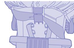
Passe o cinto diagonal do veículo pelo encaixe na parte de trás do bebê conforto.
