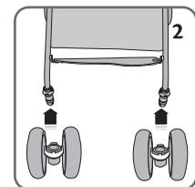
2 Monte as rodas dianteiras encaixando os soquetes das rodas nas extremidades da estrutura.
