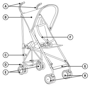
E rodas de trás A manoplas ergonômicas B capota retrátil **F** cinto de segurança **c** trava de fechamento **G** apoio para os pés **D** freios H rodas da frente
