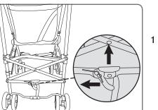
Empurre para o lado e para cima a alavanca entre as duas rodas de trás.
