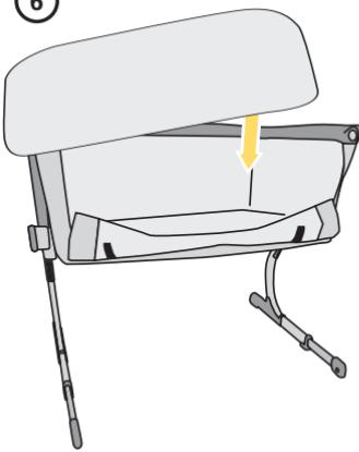
5. Busque en la parte inferior de la cubierta las tiras con velcro y fíjelas en el soporte intermedio.
