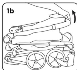
**1. Despliegue del cochecito:** suelte los seguros de transporte, ubicados en la parte frontal de los lados del cochecito, a ambos lados, luego levante la manija hasta que la estructura se bloquee.
