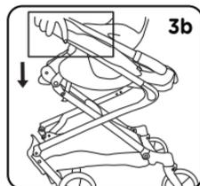
3. Junto a la rueda derecha, presione hacia abajo el seguro y lleve la estructura del cochecito hacia abajo hasta que se bloquee.
