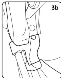
4. É possível manter os adaptadores encaixados no bebê conforto, soltando apenas a trava lateral da estrutura. O bebê conforto pode ser instalado no carro com os adaptadores encaixados.
