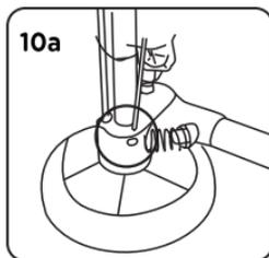
**10. Remoção das rodas traseiras:** localize o parafuso na roda traseira e remova-o com uma chave Philips não inclusa. Em seguida, localize a chapa metálica e, com ajuda de um alicate não incluso, puxe-a até retirar. Por fim, retire a roda.
