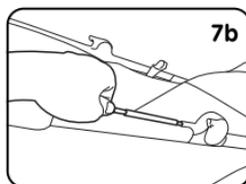
9. Para remover a capa do cesto, inicie por soltar os velcros que prendem a capa à estrutura.
