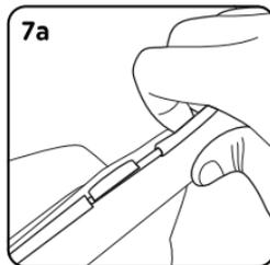
8. Solte o tecido da alavanca de inclinação do assento e, em seguida, remova todo o tecido da estrutura, puxando para cima.
