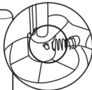
**10. Extracción de las ruedas traseras:** localice el tornillo de la rueda trasera y destornillelo con un destornillador no incluido. Luego, ubique la placa de metal y, con la ayuda de un alicate no incluido, tira de esta hasta que se retire. Finalmente, retire la rueda.
