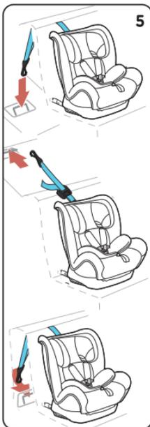
5. Passe o Top Tether por baixo do apoio de cabeça do banco e prenda no ponto de ancoragem.
