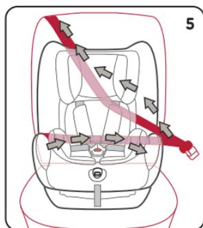
4. Pase la banda superior del cinturón del auto también por dentro, pasando por debajo de la cubierta del reposacabezas.
