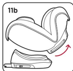
11. O assento se desconecta da sua base para mudar de lado, pressione ao mesmo tempo o botão na base e a alavanca de inclinação que fica por baixo do assento. Deslize o assento para fora da base.
