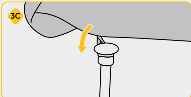
**3. Capota:** desrosqueie a trava das hastes da capota, leve-as para cima e volte a rosquear para travar. Por fim, encaixe as tiras da capota nas pontas das hastes.
