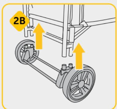
**2B.** Encaixe o conjunto das rodas traseiras na estrutura com os freios virados para fora.
